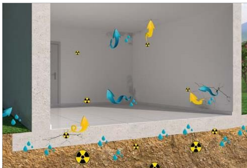
Pericolul gazului Radon și riscuri de umiditate ascendentă în interiorul unei case construite cu o fundație tradițională.
