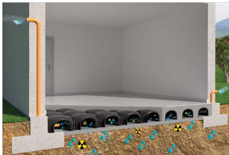
Casă construită cu fundație ventilată IGLU'®.
